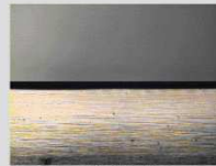
トラバースガイド使用の刃物摩耗拡大写真 When the traverse guide is used. A closeup picture of the blade worn out
