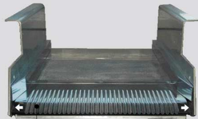
トラバースガイドはゆっくりと左右にスライドします。 The traverse guide slides in a traverse direction slowly.
